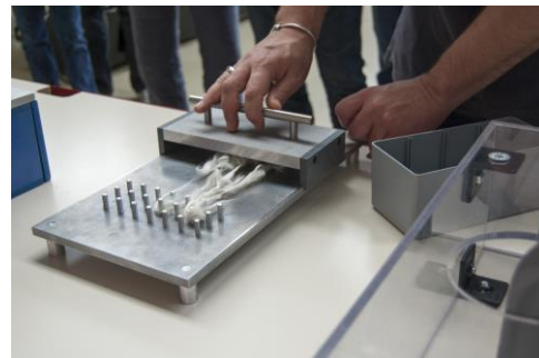
Le principe de la carte permettant l'alignement des fibres de coton
